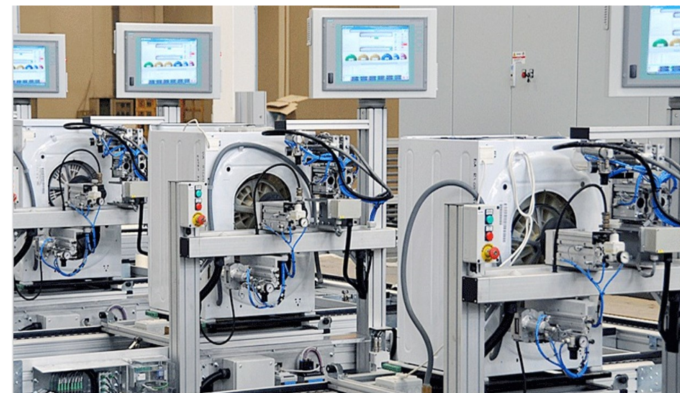
Stazione automatica del controllo qualità – interfaccia del test program
